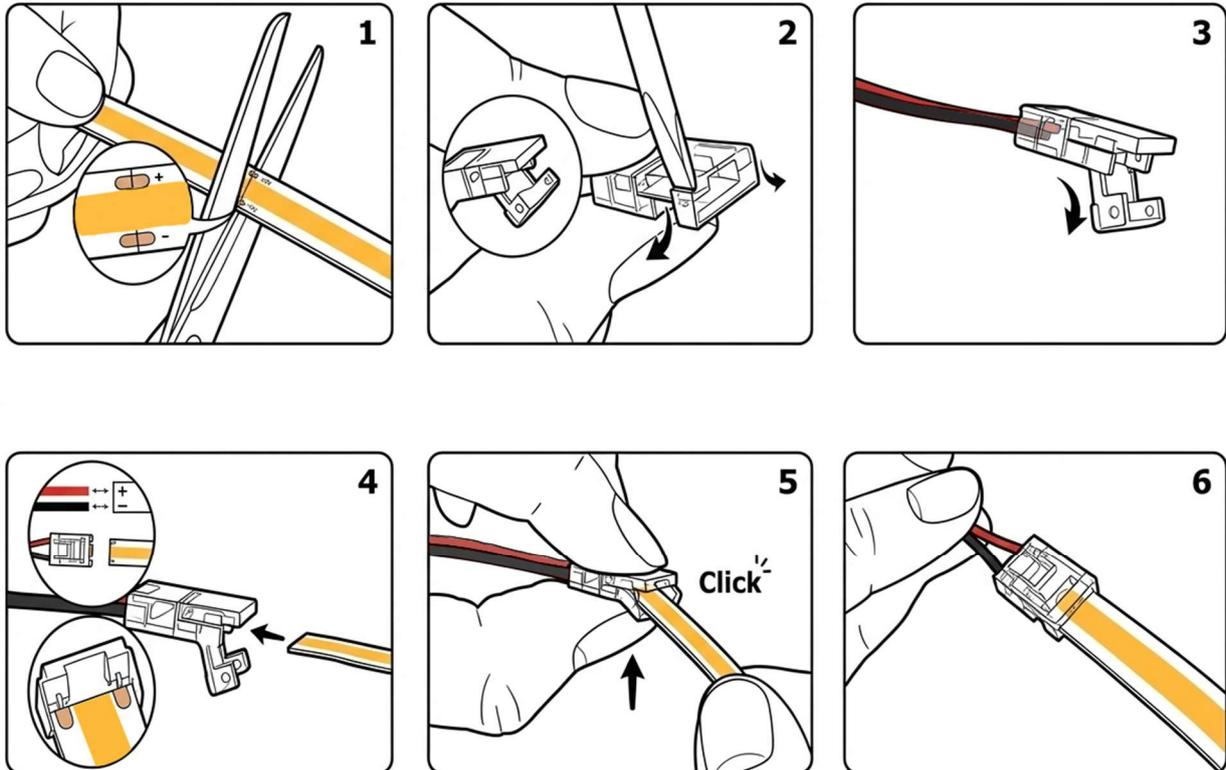
Der ursprüngliche LED-Streifen hat eine Kabelverbindung auf einer Seite. Nach dem Kürzen der LED-Streifen kann eine neue Verbindung über einen dafür vorgesehenen Verbinder hergestellt werden.
