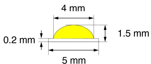
Die LED-Streifen können einfach mit dem Schneider am Schnittpunkt getrennt bzw. gekürzt werden. Auf der Rückseite der LED-Streifen befindet sich ein doppelseitiges wärmeleitendes Klebeband, wodurch eine einfache und schnelle Montage der LED-Streifen möglich ist.
