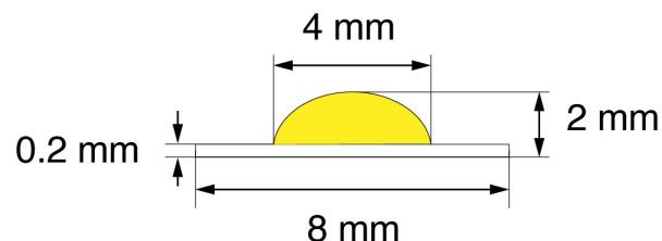
Die LED-Streifen können einfach mit dem Schneider am Schnittpunkt getrennt bzw. gekürzt werden. Auf der Rückseite der LED-Streifen befindet sich ein doppelseitiges wärmeleitendes Klebeband, wodurch eine einfache und schnelle Montage der LED-Streifen möglich ist.
