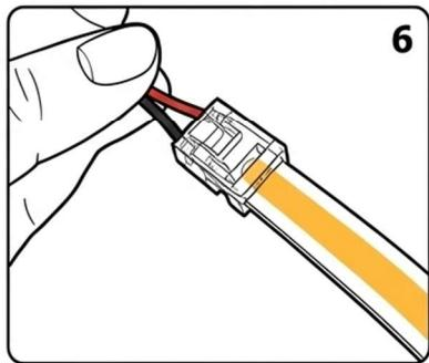
Der ursprüngliche LED-Streifen hat eine Kabelverbindung auf einer Seite. Nach dem Kürzen der LED-Streifen kann eine neue Verbindung über einen dafür vorgesehenen Verbinder hergestellt werden.
