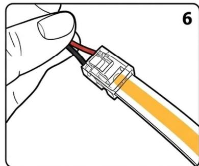
Der ursprüngliche LED-Streifen hat eine Kabelverbindung auf einer Seite. Nach dem Kürzen der LED-Streifen kann eine neue Verbindung über einen dafür vorgesehenen Verbinder hergestellt werden.
