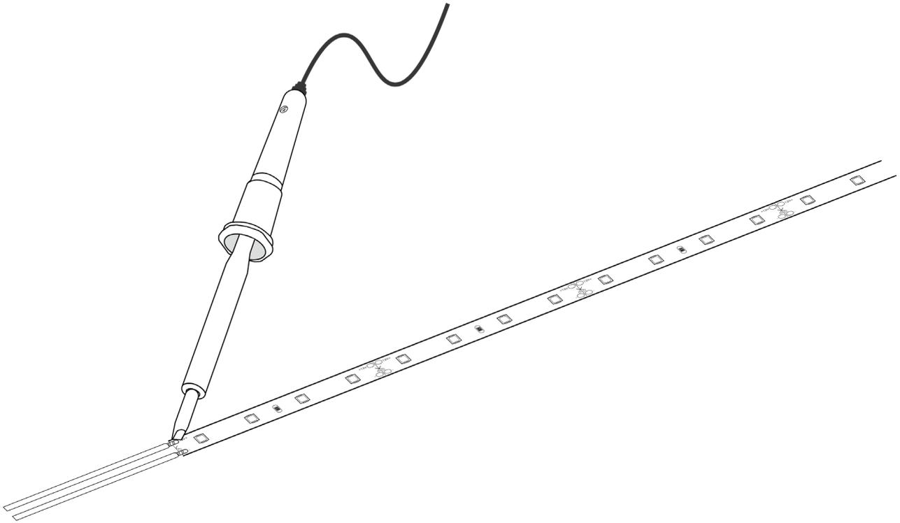
Die originale 5m LED-Streifen hat einen Kabelanschluss an der Anfangseite. Nach der Verkürzung der LED-Streifen kann ein neuer Anschluss über eine Lötverbindung an der dafür vorgesehenen Löt pads erfolgt werden.
