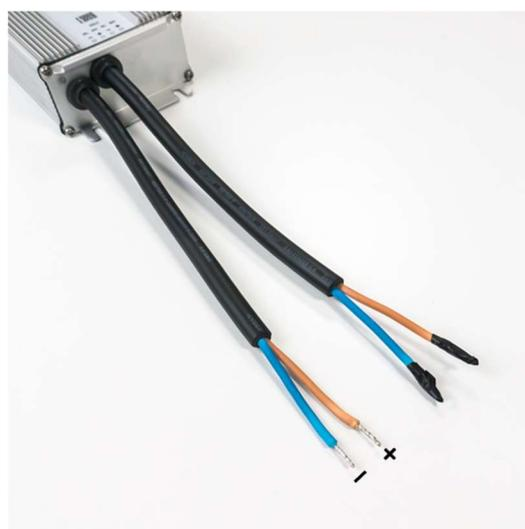
**Wenn nur ein Ausgang verwendet wird. Die nicht benötigte Ausgangskabel sollten mit Kabel Terminal oder Isolierband isoliert werden.**
