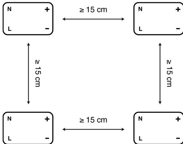
Halten Sie bei der Installation einen Abstand von mindestens **15cm** zwischen das Produkt und anderen Wärmequellen ein, z.B. anderer LED-Netzteile, Leuchtkörper/LEDs etc.
